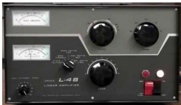
L-4B Linear Amplifier (2x 3-500z Eimac Tubes)
